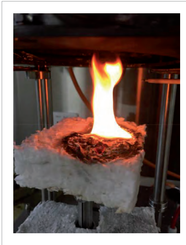
Figura 15. Envase mostrado en la Figura 12 después de 30 segundos de exposición a 16 \text{ kW/m}^2 (21 de julio, 2015).
