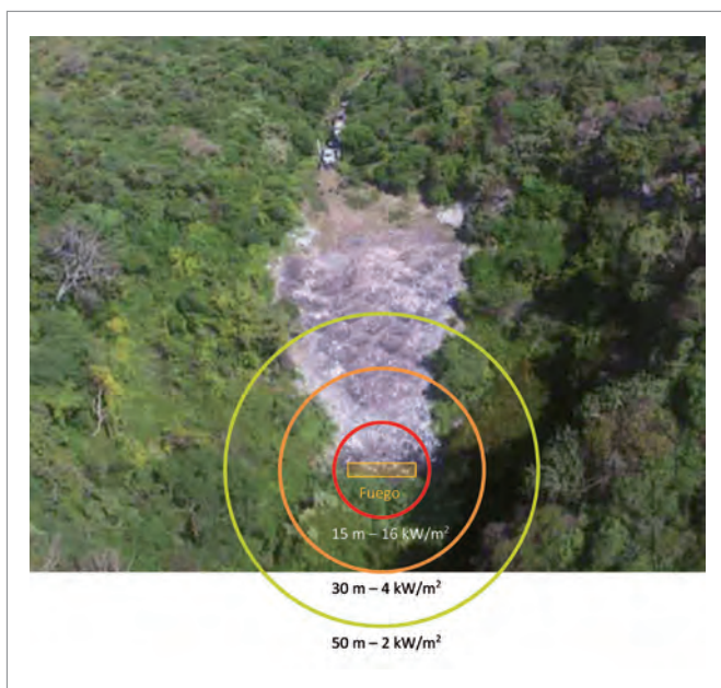
Radiación recibida a diferentes distancias del fuego mínimo necesario para la cremación de los cuerpos.
