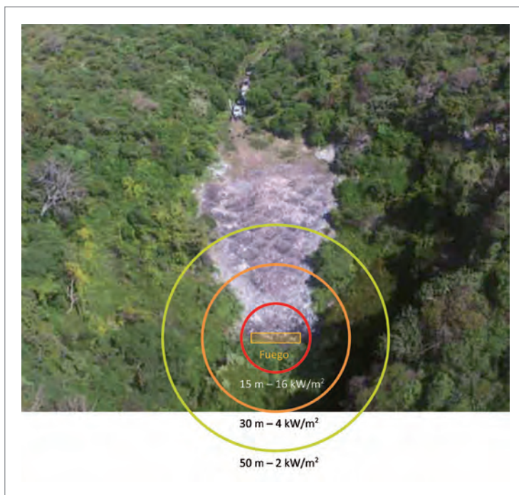
Figura 11. Radiación recibida a diferentes distancias del fuego mínimo necesario para la cremación de los cuerpos.
