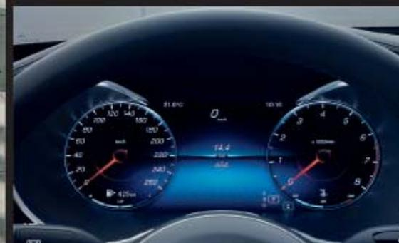
Visualizador del cuadro de instrumentos completamente digital.
